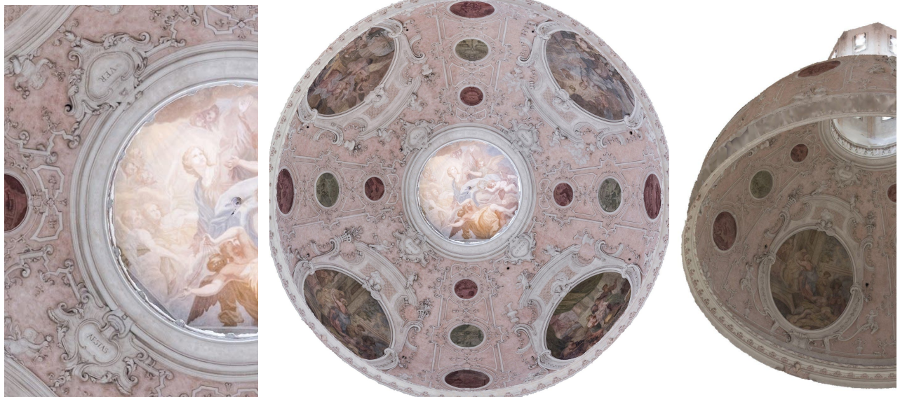
Beispiel Orthofoto aus Photogrammetrie
